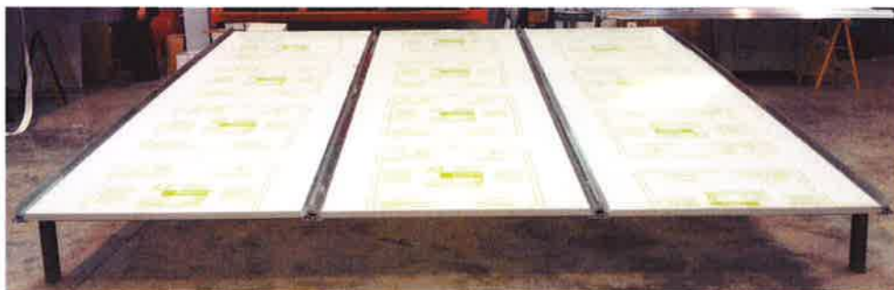
Verrière en panneaux polycarbonate
