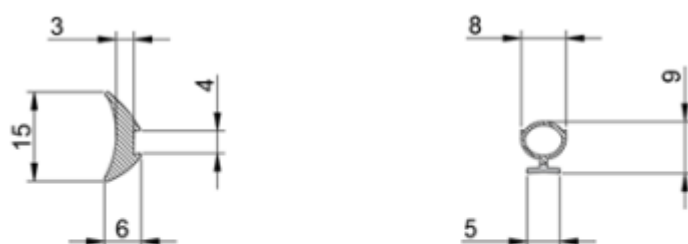
Figure 8 - Jonction des profilés en aluminium à rupture de pont thermique
